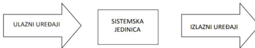
Slika 2. Princip rada računala ( preuzeto sa Čelebić i Rendulić, 2011.).
