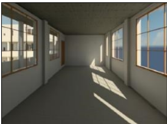
Slika 28: Dvostrano osvjetljenje prostorije s paralelno postavljenim glavnim i sekundarnim prozorima
